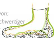
Zeichnung (oben): das Granulat - schwarze Punkte - befindet sich in einer speziell entwickelten, flexiblen Kammerkonstruktion.
